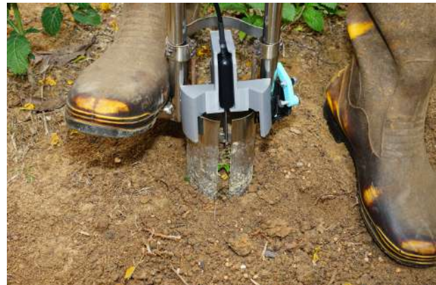
Gambar: Penggunaan alat Fertilizer Auger oleh pembantu awam landskap.
