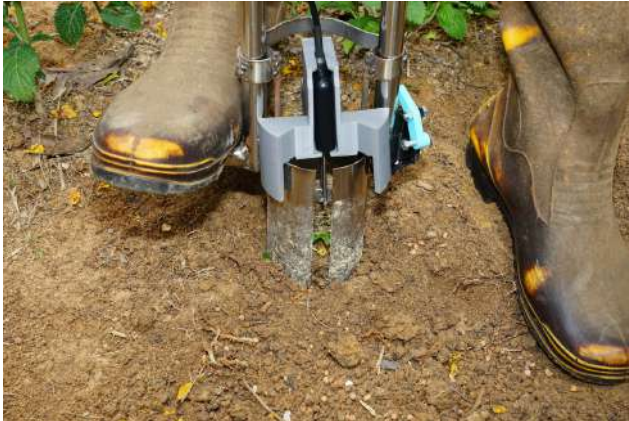
Gambar: Penggunaan alat Fertilizer Auger 3.0 oleh pembantu awam landskap.
