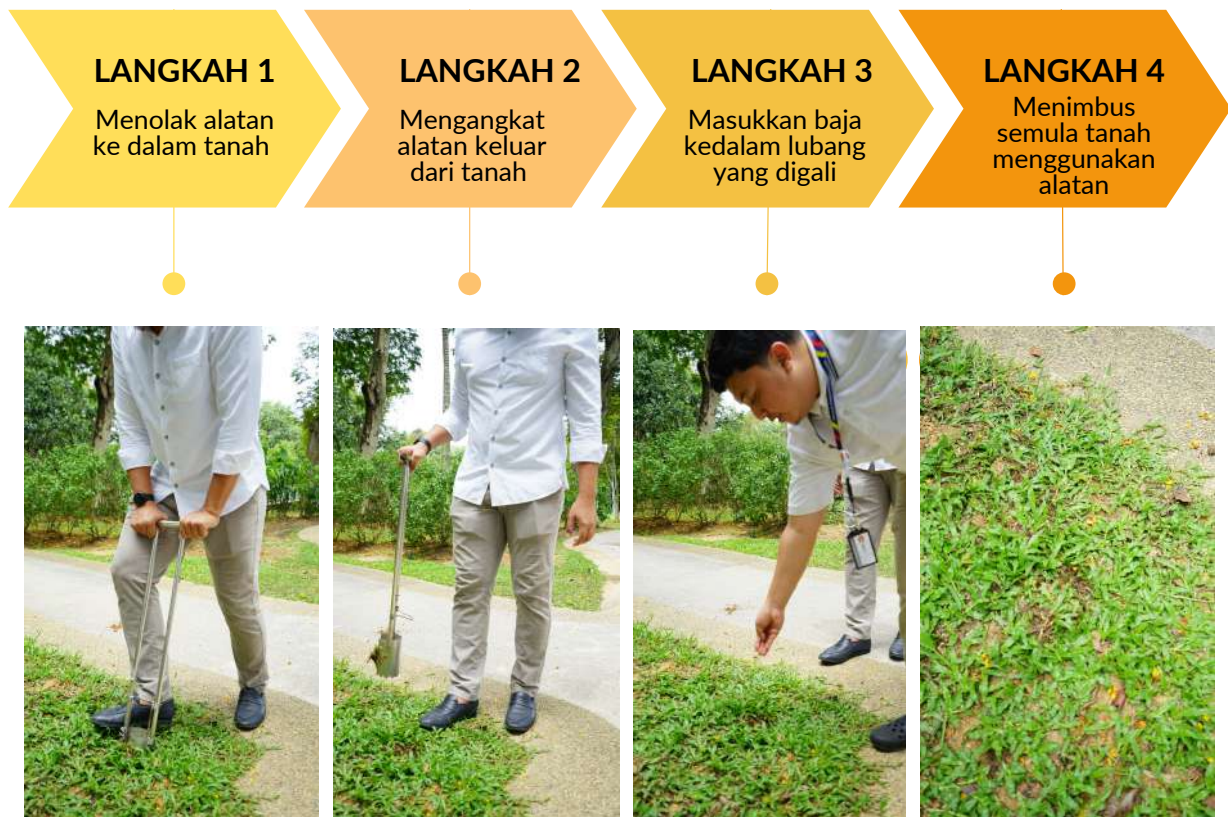
Gambar: Kaedah pembajaan menggunakan alatan Fertilizer Auger prototaip 1.0.
