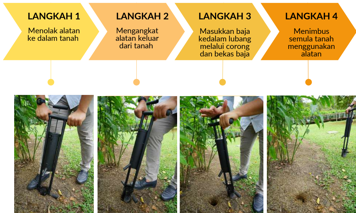
Gambar: Kaedah pembajaan menggunakan alatan Fertilizer Auger prototaip 2.0.
