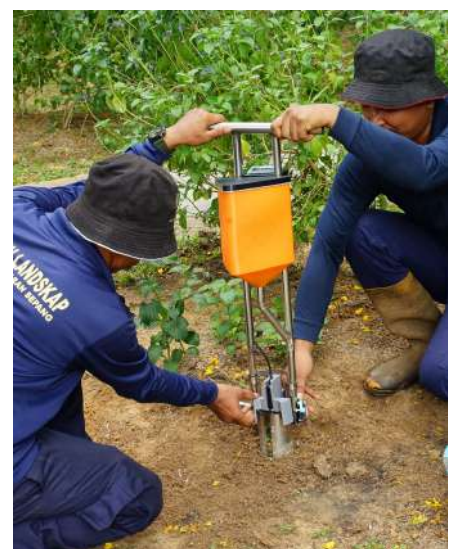
Gambar: Pengujian dan penggunaan alat Fertilizer Auger 3.0 di tapak
