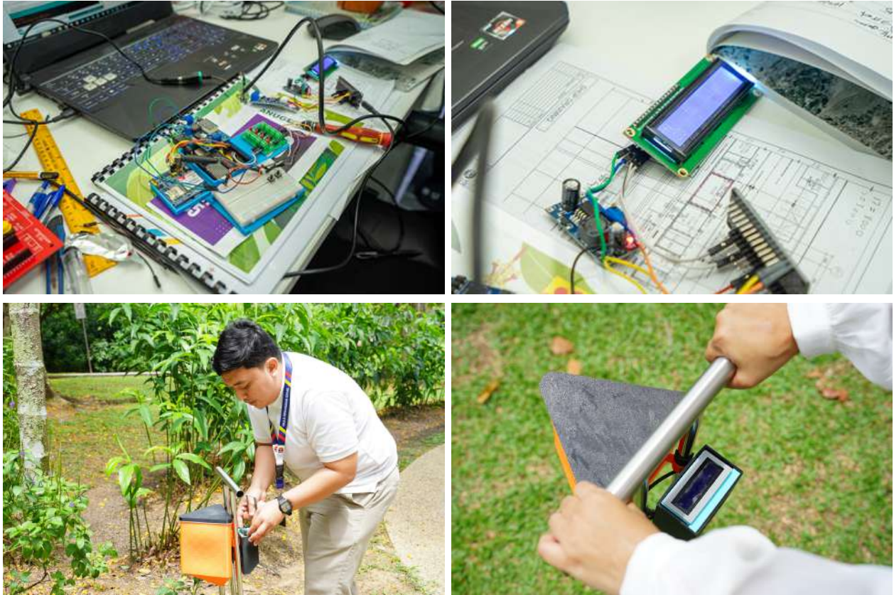
Gambar: Pemasangan komponen skrin panel pada alat Fertilizer Auger 3.0.
