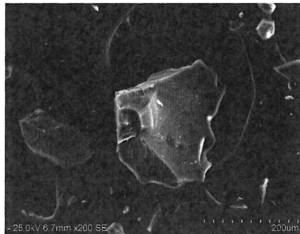
Rajah 2: Imej xerogel silika melalui Mikroskop Elektron Imbasan
