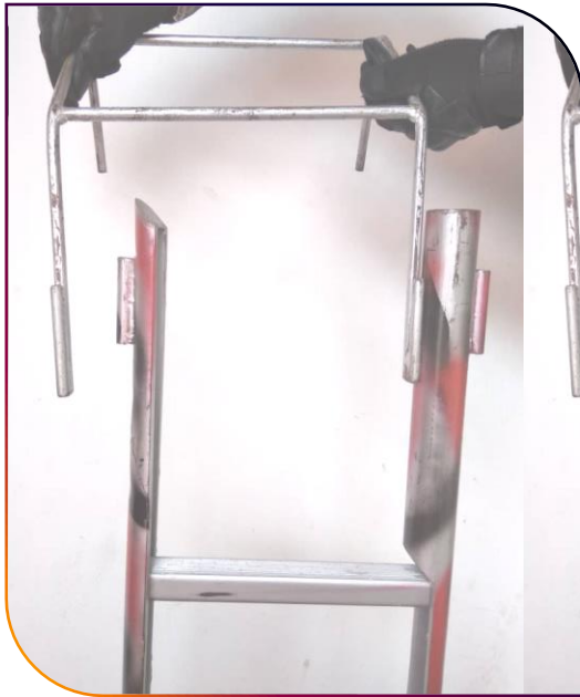
Gambar 5.8 Tatacara pemasangan Tangga Cangkuk pada ‘KLIA SMART LADDER’
