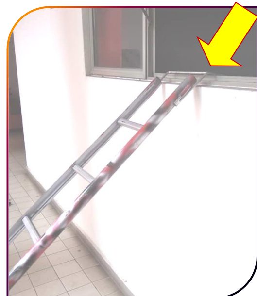
Gambar 5.8.1: Tangga Cangkuk yang siap dipasang pada ‘KLIA SMART LADDER’
