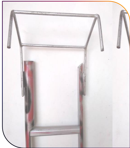
Gambar 5.8 Tatacara pemasangan Tangga Cangkuk pada ‘KLIA SMART LADDER’
