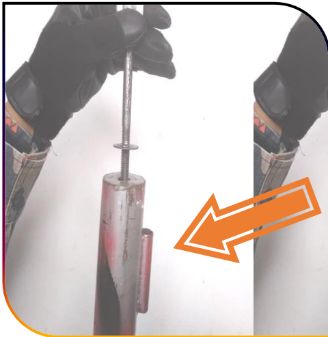
Gambar 5.2: Alat aksesori perlu di skrew untuk dipasang
