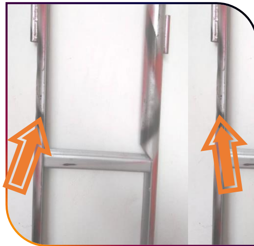
Gambar 5.3: Terdapat dua lubang disisi kedua kiri dan kanan kepala tangga yang boleh disesuaikan aksesori jenis tangga cangkuk
