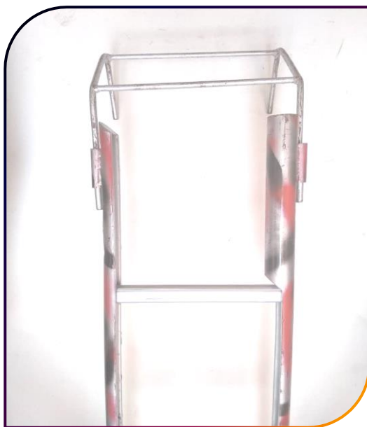
Gambar 5.8.1: Tangga Cangkuk yang siap dipasang pada ‘KLIA SMART LADDER’
