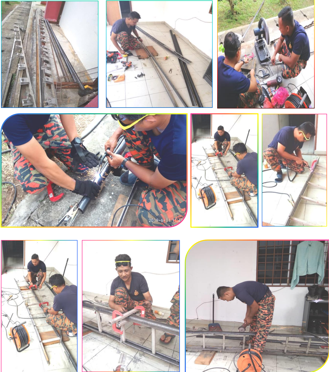
Gambar 3.1.3: Proses penyediaan bahan, pemotongan, membelah batang besi hollow , penyambungan anak tangga & kimpalan.
