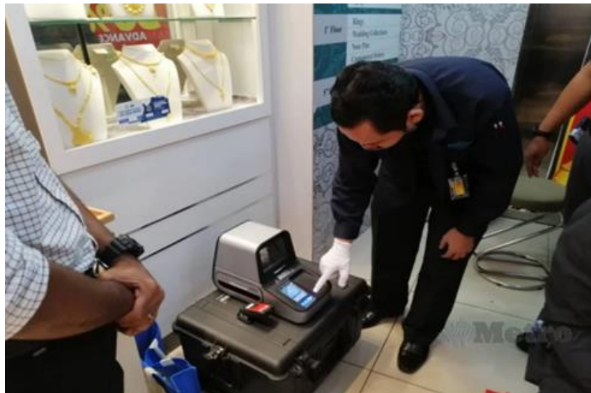
Gambar 12: Kit standard MyReM Au digunakan semasa proses verifikasi XRF mudah alih oleh pihak KPDN. Model peralatan XRF yang digunakan oleh pihak KPDN telah mendapat kelulusan reka bentuk (PA) dari NMIM
